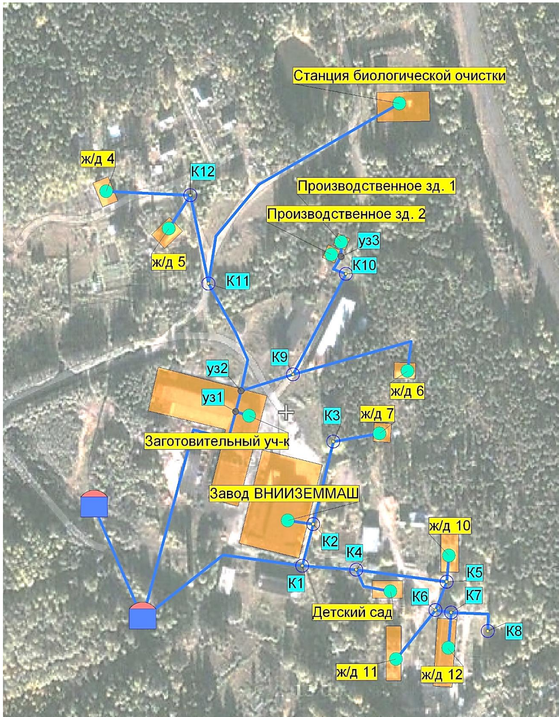
Рисунок 1.2.5.1. Схема водопроводных сетей п. Платформа 69 км.
