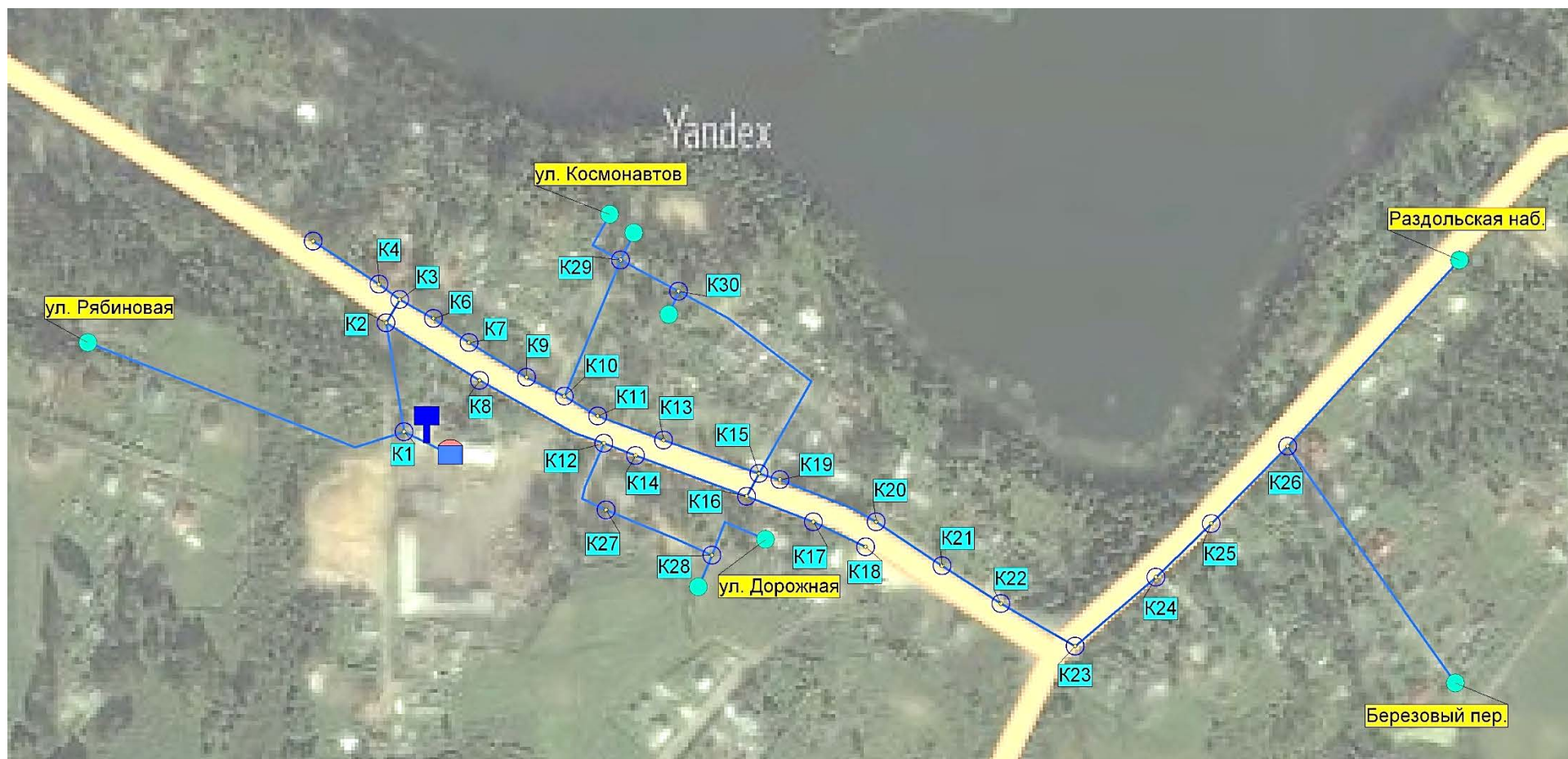
Рисунки 1.2.5.7 Схема водопроводных сетей п. Сосново (ул. Дорожная).
