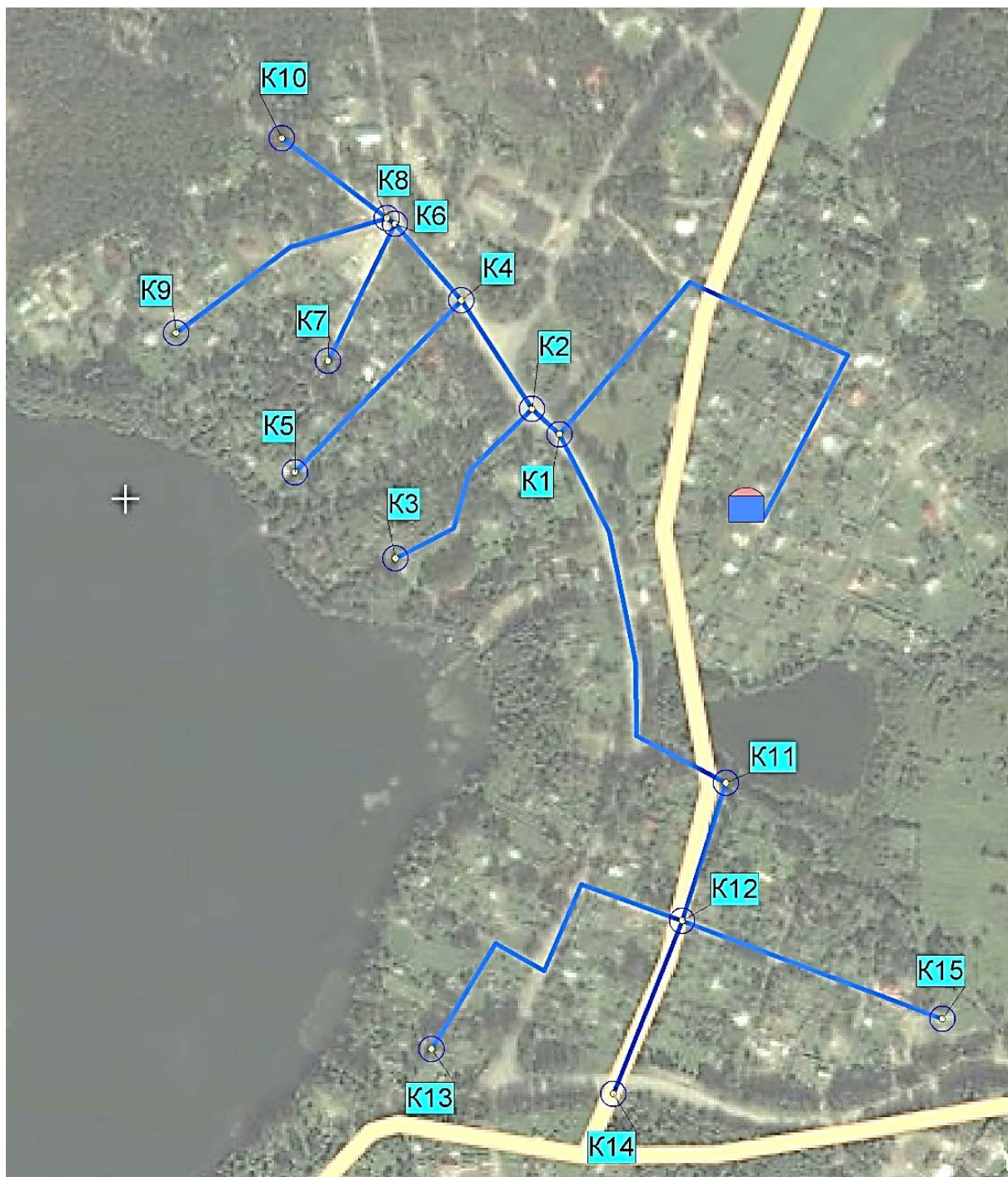
Рисунок 1.2.5.4. Схема водопроводных сетей п. Сосново (ул. Северная).
